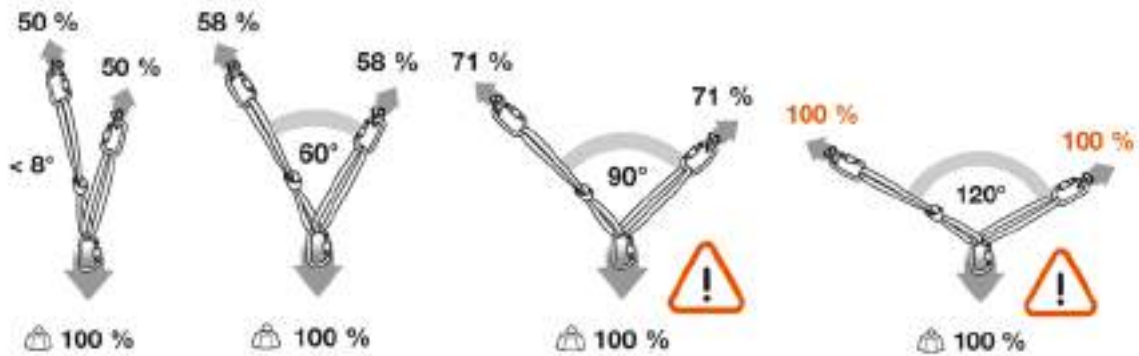
Abb. 59: Einfluss des Winkels bei Verankerungen an zwei Fixpunkten (Petzl)
