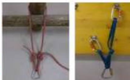
Verankerung um Mast
