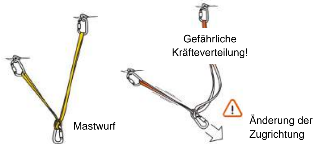
Abb. 54: Redundante Verankerung statisch an zwei Fixpunkten mit Bandschlinge (Petzl)
