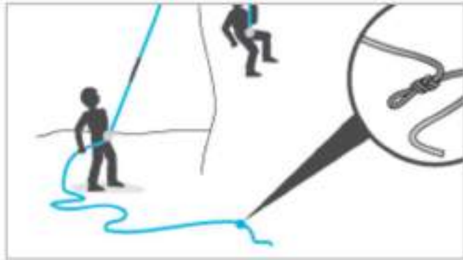
Abb. 36: Jedes Seilende muss gesichert sein (Petzl)
