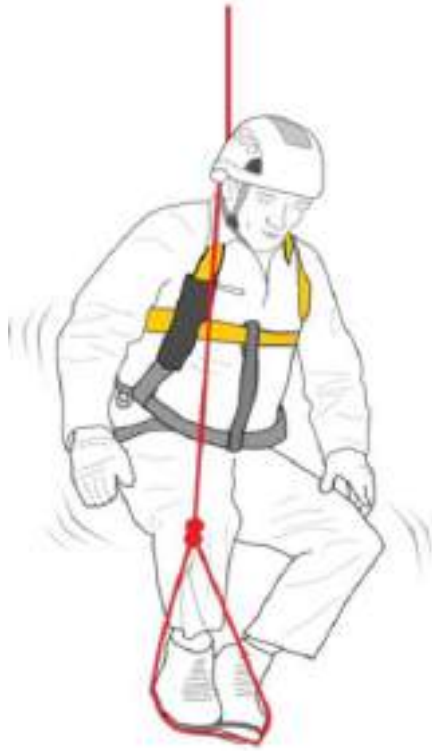
Abb. 19: Entlasten der Beine mit einer Trittschlinge (Petzl)
