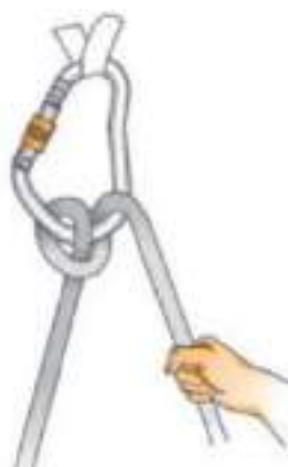
Abb. 41: HMS und Blockierungsknoten (SAC)
