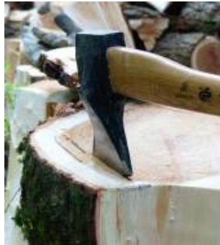
Abb. 35: Bei schwer zu spaltendem Holz werden zuerst Scheite vom Rand abgetragen (Philip Seemann)
