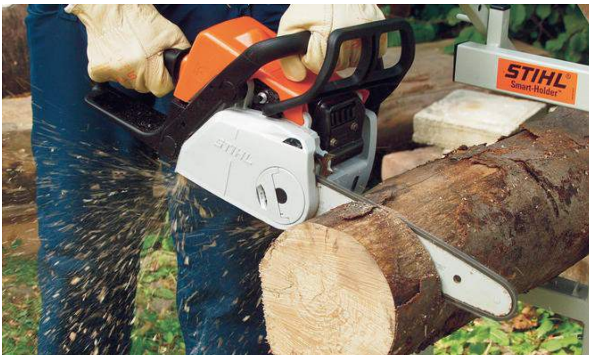
Abb. 11: Motorsäge sicher führen, korrekte Stellung der rechten Hand und Position des Daumens der linken Hand sowie der Beine (STIHL)
