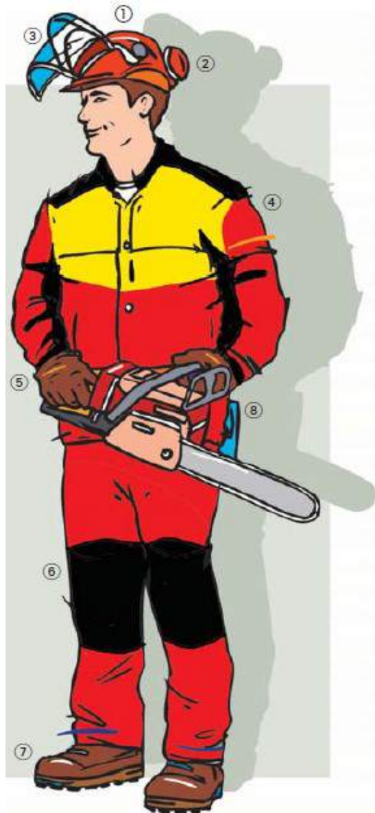
Abb. 2: PSA bei Motorsägearbeiten (SUVA)
