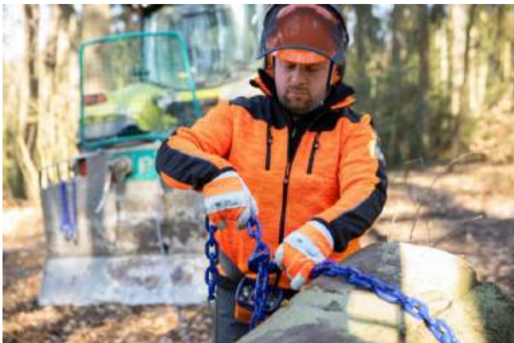
Abb. 36: Verwendung von sogenannten Rückeketten oder Drahtseilen ist Pflicht
