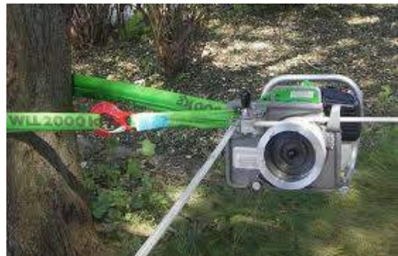
Abb. 29: Anschlagen der Winde (Eder Maschinenbau GmbH)
