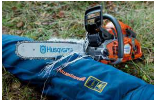
Abb. 3: Säge beim Kontakt mit Schnittschutzhose (Husqvarna)
