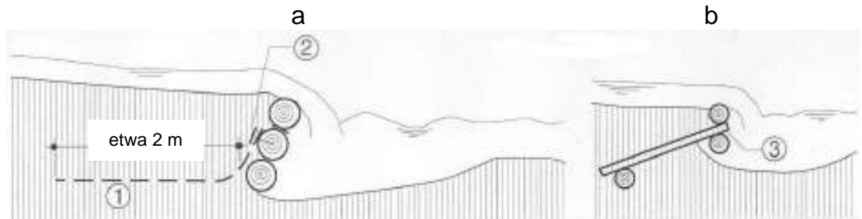
Abb. 64: Unterbindung der Sickerströmung
