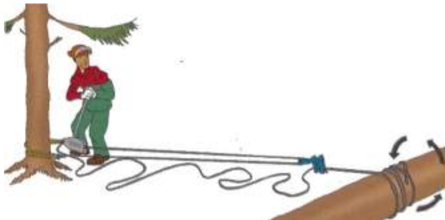
Abb. 26: Stamm liegend drehen mit doppeltem Seilzug (WaldSchweiz)
