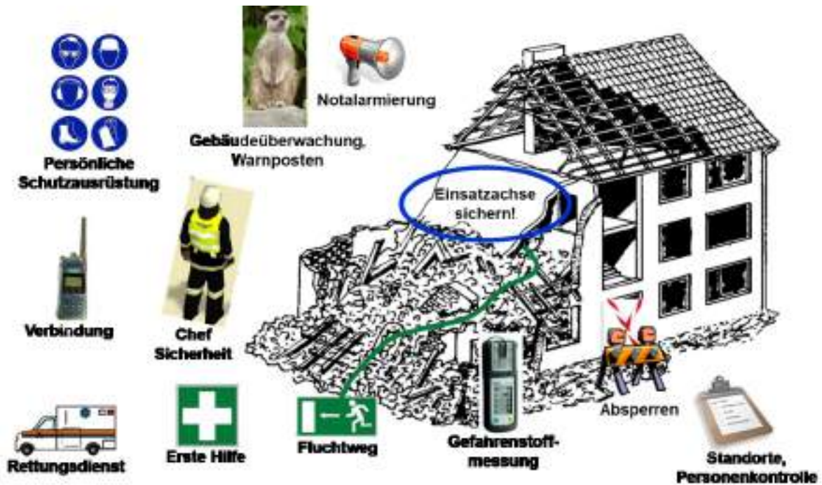
Abb. 33: Überblick Sicherheits- und Notfallmassnahmen
