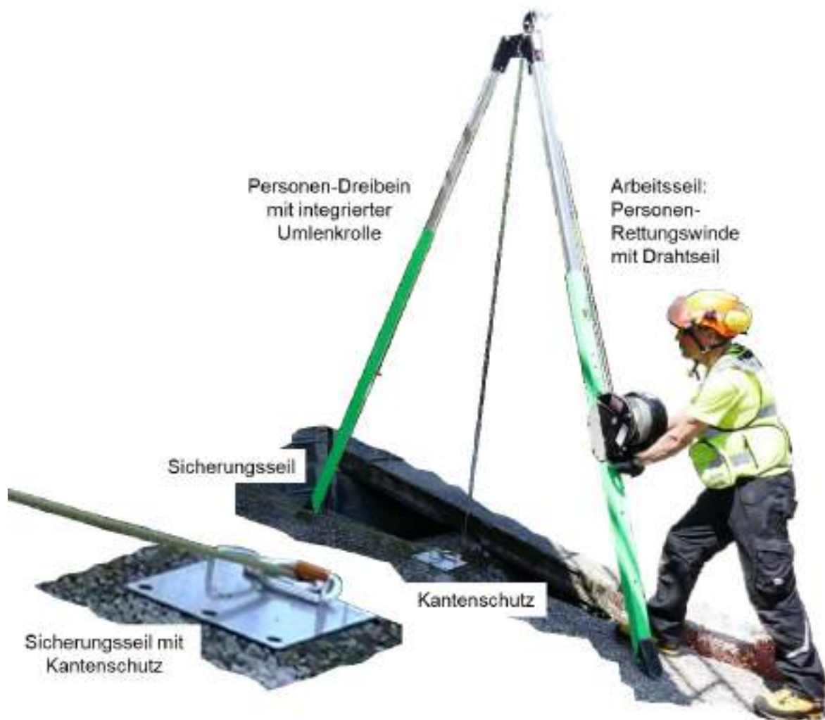
Abb. 70: Rettung mit einem Personendreibein und einer Personen-Rettungswinde (Bild ohne Absturzsicherung)
