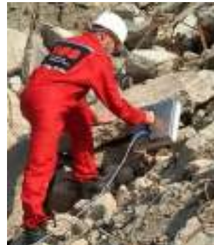
Abb. 42: Beispiel Bio-Radargerät (MEDER)
