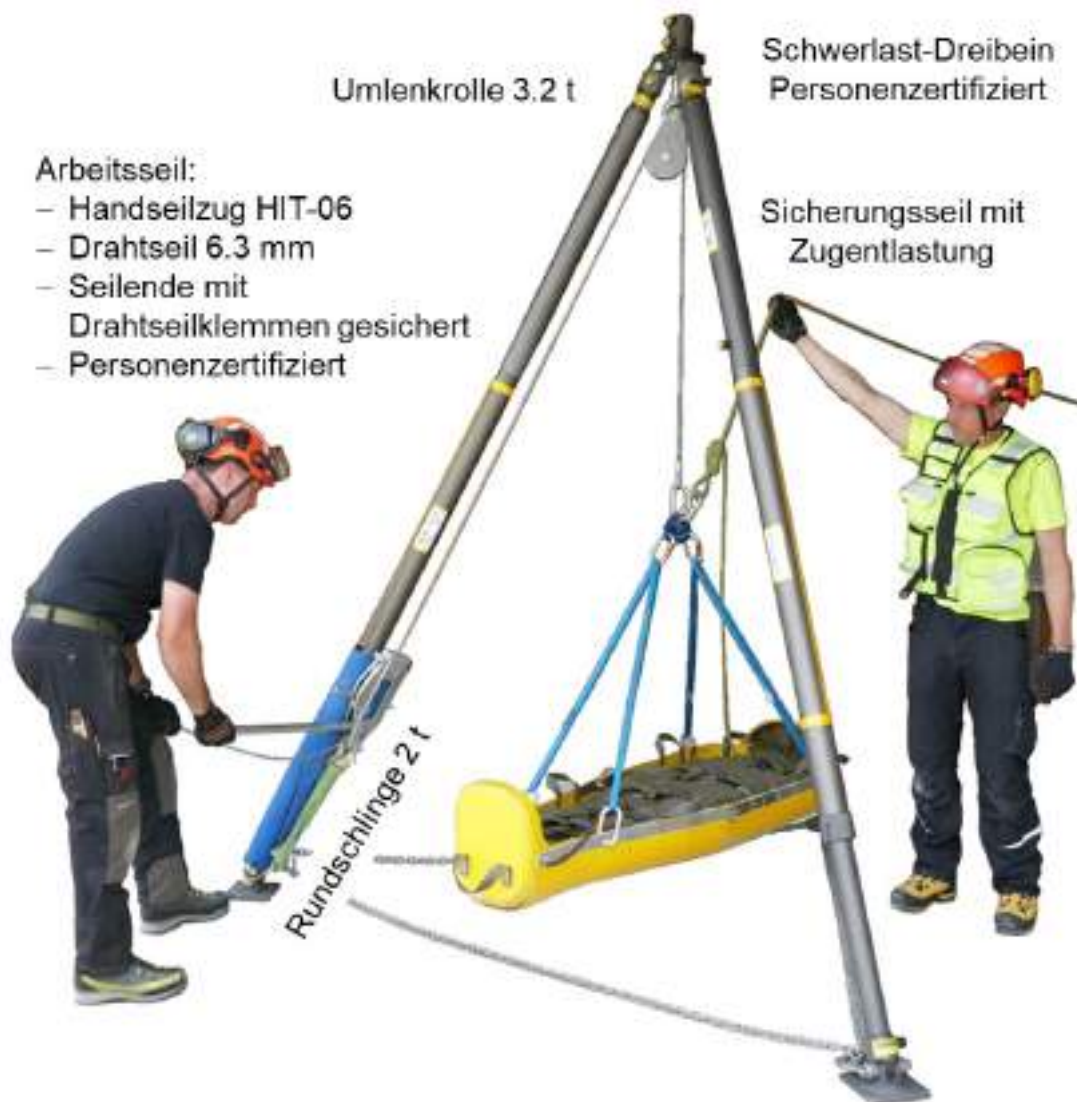
Abb. 73: Rettung mit einem Schwerlastdreibein und einem zertifizierten Handseilzug
