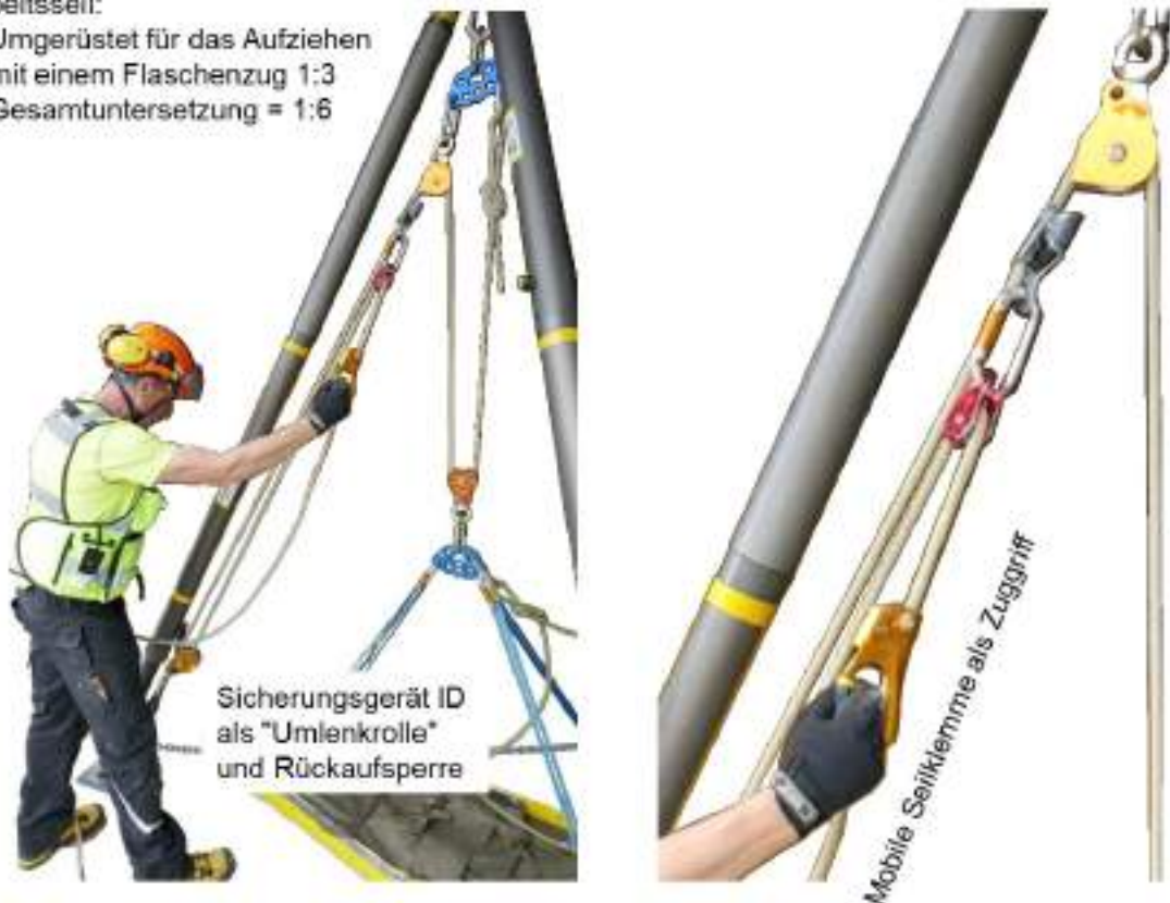
Abb. 72: Aufziehen einer Bahre mit einem Schwerlastdreibein und einem Universal-Flaschenzug (Bild ohne Absturzsicherung)
