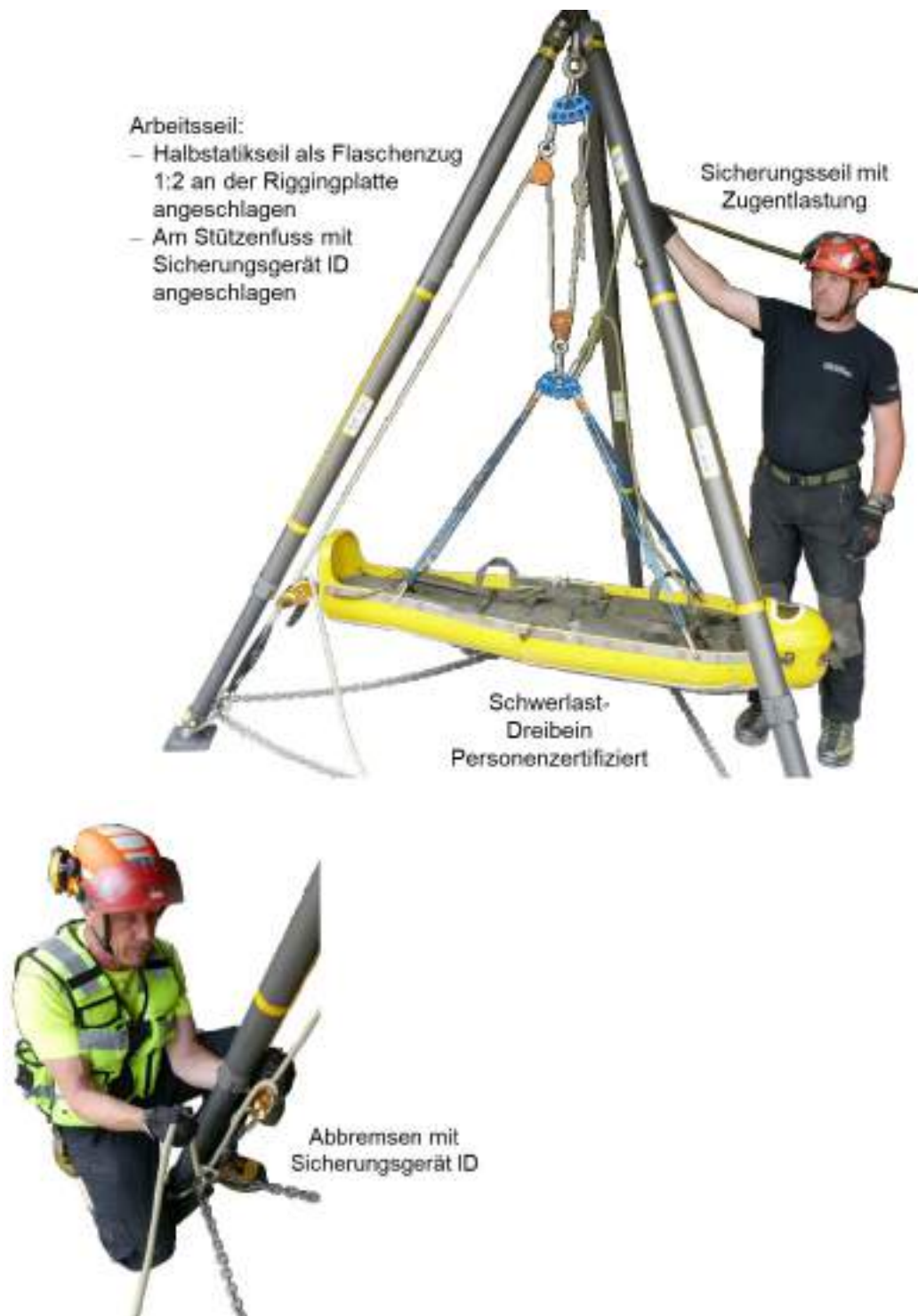
Abb. 71: Abseilen einer Bahre mit einem Schwerlastdreibein und einem Universal-Flaschenzug (Bild ohne Absturzsicherung)
