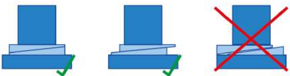
Abb. 39: Richtige und falsche Positionierung der Keile (Blockhaus, THW)
