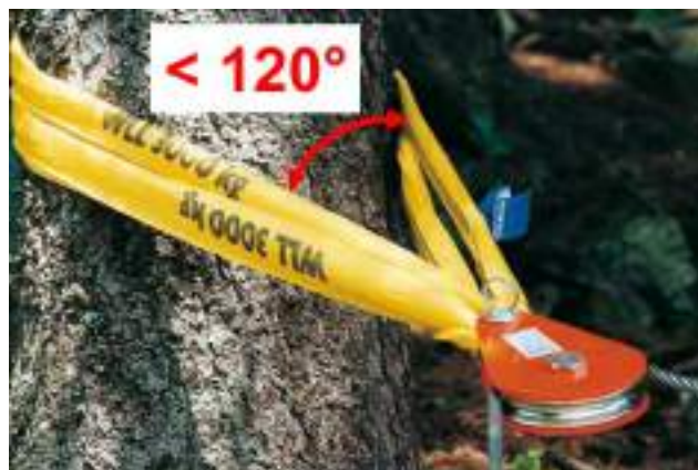
Abb. 23: Zulässiger Spreizwinkel von Verbindungsmitteln oder -elementen.
