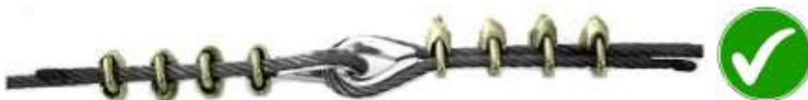
Abb. 32: Verbinden von Drahtseilen mit doppelter Schlaufe (BAD Gesundheitsvorsorge und Sicherheitstechnik GmbH).
