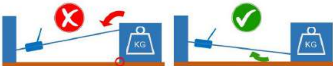
Abb. 40: Falsches und richtiges Ziehen einer Last.
