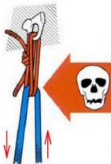
Abb. 33: Gefahr der Schmelzverbrennung bei Faserseilen.
