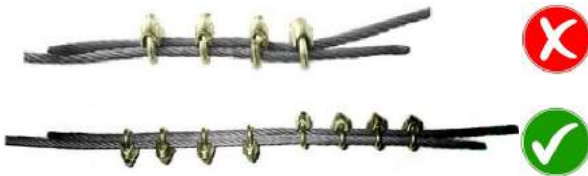
Abb. 31: Richtige Anordnung von Seilklemmen beim Verbinden von parallel verlaufenden Seilenden (BAD Gesundheitsvorsorge und Sicherheitstechnik GmbH).
