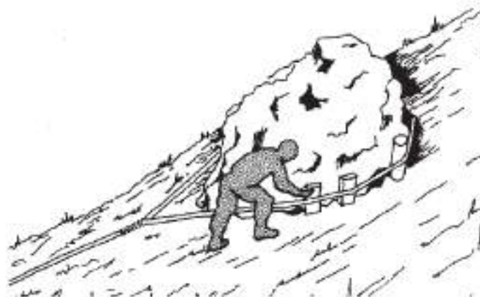
Abb. 16: Verankerung an einem Felsblock (Schweizer Armee).
