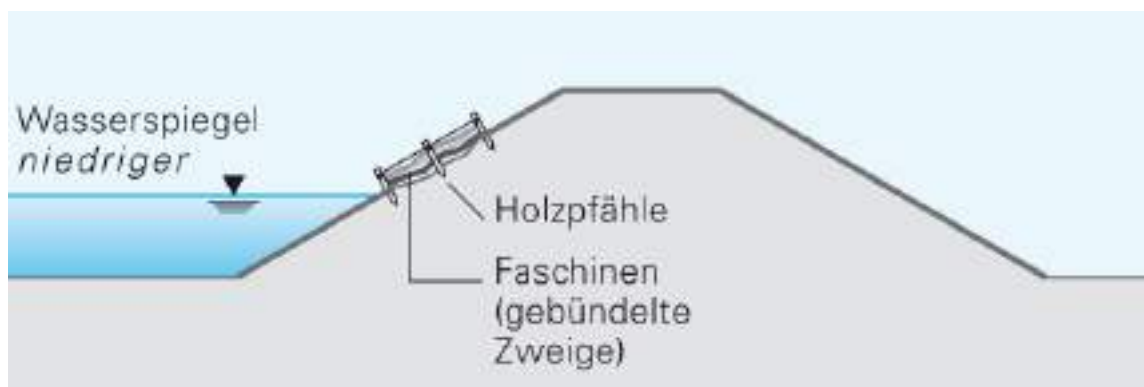
Abb. 77: Einbauen von Faschinen in einen Damm (Bayerisches Landesamt für Umwelt).
