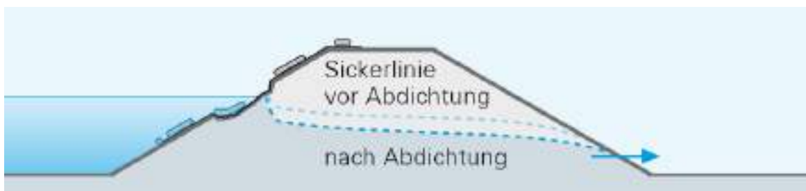
Abb. 79: Abdichten des Damms mittels Folie (Bayerisches Landesamt für Umwelt).
