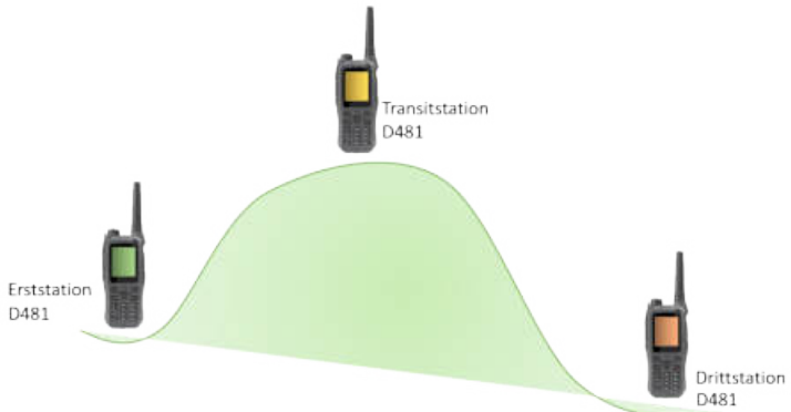
Abb. 5: Einsatz einer Transitstation.
