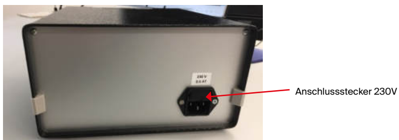
Abb. 63: Anschluss des Master-Modems ZS-NAG (hinten).
